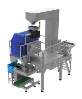
上海卫岚电子科技股份有限公司高速数粒机是一款视觉数粒机,有别于传统的电子计数数粒机,视觉数粒机 采用突破性原理,高速取像、整堆计数、逻辑分配,基于高速视觉技术逻辑分配的数粒方法。具有 几大优势: 1、遥距取像,不受粉尘影响; 2、高解像度,可检破片碎粒,小堆剔除; 3、物料整堆计数,高速准确; 4、逻辑分配,无需高速闸门; 5、整合通道,无需多层分料分道,节省空间6、设备具有学习功能每一款产品能兼容不同物料不同数粒要求,扩充了设备的性能上海卫岚视觉数粒设备数粒精度高,为用户大幅降低了物料成本浪费。医药D850多通道视觉数粒机厂家直供
